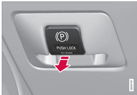
Ovládání parkovací brzdy - uvolnění.
