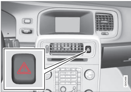
Tlačítko pro výstražnou funkci ukazatelů směru.
