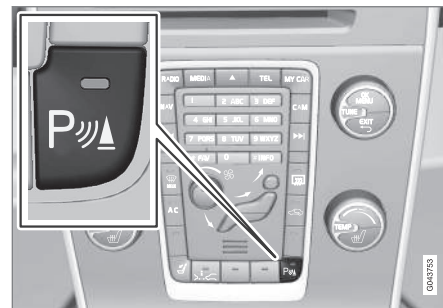
Kontrolka Zapnuto/Vypnuto parkovací asistence a funkce CTA*.
