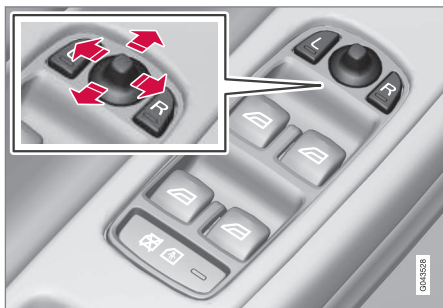
Ovládací prvky vnějších zpětných zrcátek.
