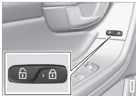
Tlačítko centrálního zamykání
