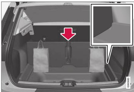
1. Levez la poignée placée au centre du plancher du compartiment à bagages et soulevez le plancher.
