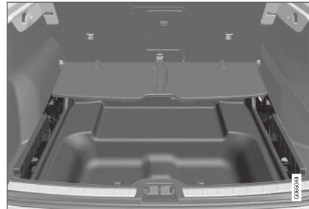
Pliez le plancher pliable de compartiment à bagages vers l'avant.
