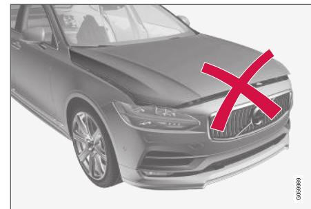
Capot partiellement fermé. L'illustration est schématique, les détails peuvent varier selon le modèle de la voiture.
