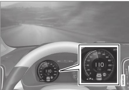
L'illustration précédente<sup>56</sup> indique que le régulateur adaptatif de vitesse est réglé pour maintenir une vitesse de 110 km/h (68 mph) et qu'il n'y a aucun véhicule à suivre.
