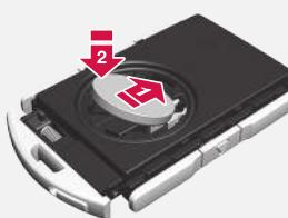
5 Installez un pile neuve avec la face + vers le haut. Évitez de toucher les contacts de la télécommande avec les doigts.
