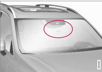
La zone indiquée ne doit pas être couverte (ni autocollant, ni filtre solaire, ni aucun autre objet, etc.)<sup>68</sup>.
