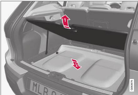
La plage arrière décrochée peut être rangée sous le plancher du compartiment à bagages.
