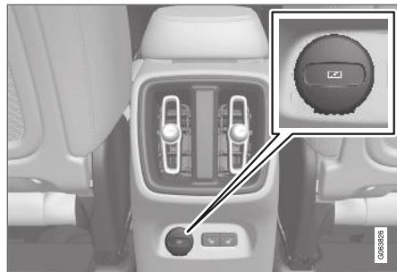
Prise USB\* (type C) à l'arrière de la console de tunnel pour le chargement d'un téléphone d'une tablette par exemple<sup>5</sup>.
