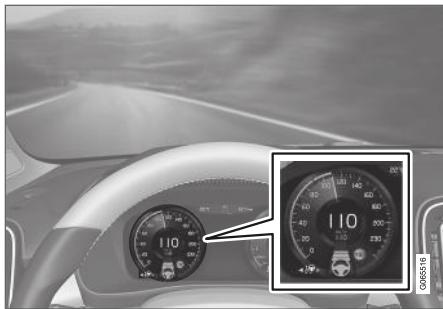
L'illustration précédente<sup>63</sup> indique que Pilot Assist est réglé pour maintenir une vitesse de 110 km/h (68 mph) et qu'il n'y a aucun véhicule à suivre.
