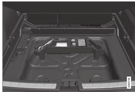
Le bloc de mousse sous la plancher du compartiment à bagages renferme l'œillet de remorquage, le kit de réparation de crevaison, l'outil de dépose des capuchons en plastique des boulons de roue et la douille pour le boulon antivol.
