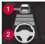
Ce n'est que lorsque le symbole de volant (2) passe de GRIS à VERT que la correction de trajectoire Pilot Assist est active.
