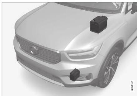
La batterie d'appoint se trouve en bas dans le compartiment moteur. L'illustration montre aussi la batterie de démarrage (en haut).
