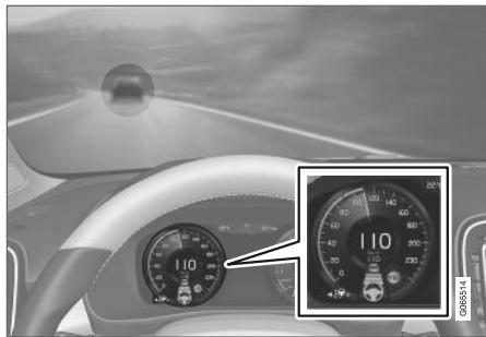
L'illustration précédente<sup>63</sup> indique que Pilot Assist est réglé pour maintenir une vitesse de 110 km/h (68 mph) et qu'il suit un véhicule qui roule à la même vitesse.
