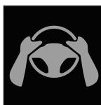
Si Pilot Assist détecte que le conducteur n'a pas les mains sur le volant, il est invité par un symbole et un message texte à reprendre activement le contrôle de la voiture.
