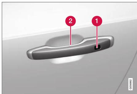
① Dépression tactile pour le verrouillage
