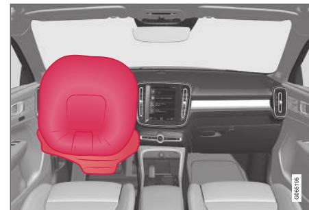
Coussin gonflable dans le volant et coussin gonflable de genoux<sup>1</sup> du siège avant, côté conducteur.
