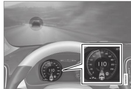
L'illustration précédente<sup>63</sup> indique que Pilot Assist est réglé pour maintenir une vitesse de 110 km/h (68 mph) et qu'il suit un véhicule qui roule à la même vitesse.
