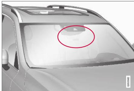
La zone indiquée ne doit pas être couverte (ni autocollant, ni filtre solaire, ni aucun autre objet, etc.)<sup>64</sup>.
