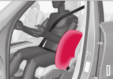
Les coussins gonflables latéraux sont montés dans les cadres extérieurs des dossier des sièges avant et aident à protéger le conducteur et le passager des sièges avant.
