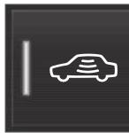
Appuyez sur le bouton **Protection réduite** de la vue Fonctions sur l'écran central pour désactiver temporairement la fonction des serrures à pêne dormant.
