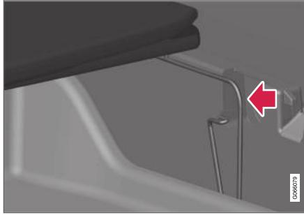
Tenez le plancher soulevé et appuyez sur le ressort de verrouillage de l'autre côté, à l'endroit indiqué par la flèche.
