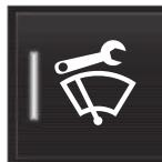
Appuyez sur le bouton **Posit. entretien essuie-glace**. Le témoin du bouton s'allume lorsque la position d'entretien est activée. À son activation, les essuie-glace montent et restent en position verticale. Pour désactiver la position d'entretien, appuyez à nouveau sur **Posit. entretien essuie-glace**. Le témoin du bouton s'éteint lorsque la position d'entretien est désactivée.
