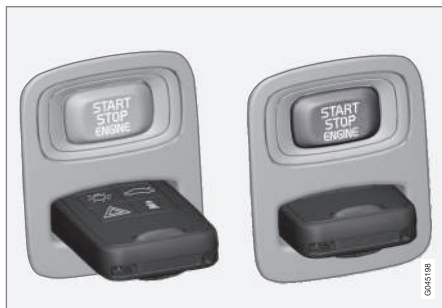
Blocchetto di accensione con chiave telecomando estratta/inserita.
