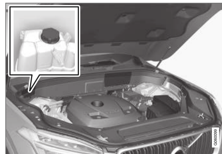
Deposito de expansión del sistema de refrigeración.
