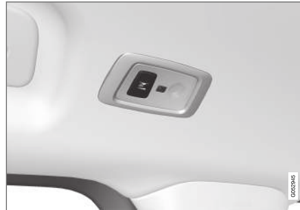
Los vehículos con techo panorámico* tienen dos unidades de luces, una a cada lado del techo. 7
