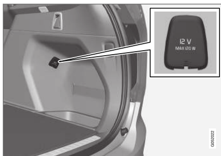
Toma eléctrica de 12 V en el compartimento de carga*.
