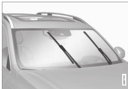
Escobillas de limpiaparabrisas en posición de servicio.
