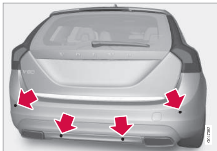
Posizionamento dei sensori posteriori.
