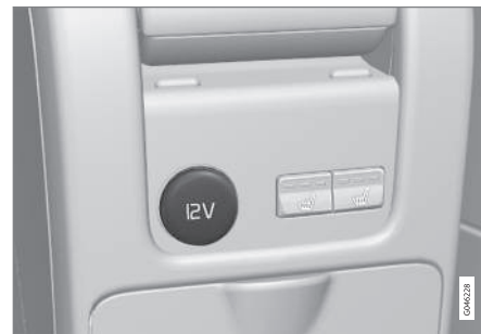
Preso da 12 V nel tunnel, sedile posteriore.
