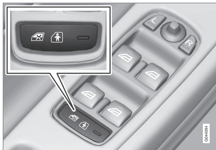
Pannello di comando nella portiera del conducente.
