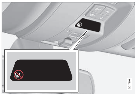
Indicazione dell'airbag lato passeggero attivato.
