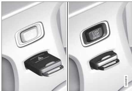
Contactslot met transpondersleutel uitgetrokken/ ingedruwd en knop START/STOP ENGINE .
