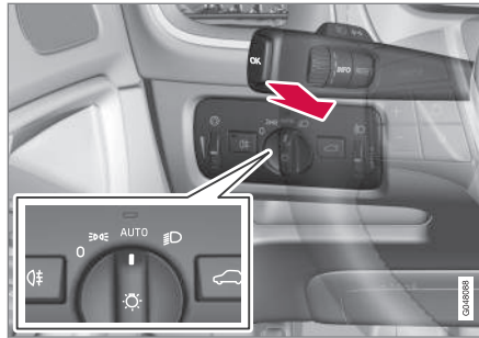
Stuurhendel en verlichtingsdraaiknop in stand AUTO .
