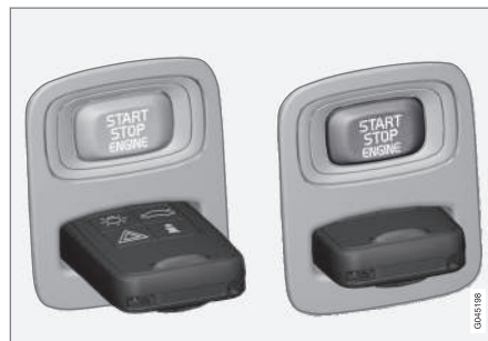
Fente d'allumage avec clé-télécommande et bouton START/STOP ENGINE .
