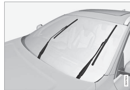
Balais d'essuie-glace en position d'entretien
