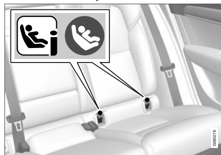
Tvirtinimo taškų vietos parodytos simboliais 2 ant atlošo apmušalų.
