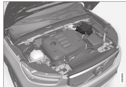
Starterio akumuliatorius įrengtas variklio skyriuje.
