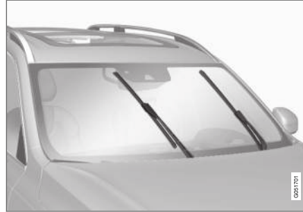
Valytuvo šluotelės aptarnavimo padėtyje.
