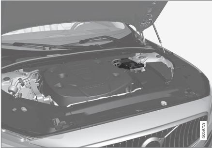
Pagalbinis 12 V akumulatorius yra dėžėje šalia statramsčio bokštėlio.
