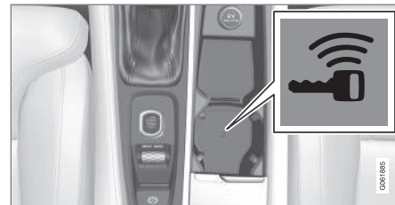
Atsarginės skaityklės vieta tunelio valdymo pulte.
