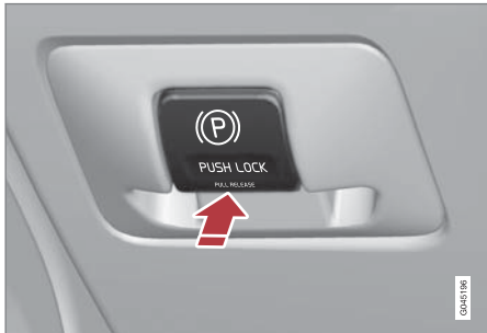
駐車煞車控制 - 使用。
