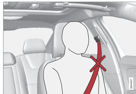
未正確繫上的安全帶。安全帶必須靠在肩膀上。
