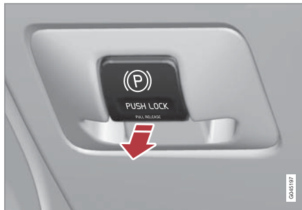
駐車煞車控制 - 釋放。
