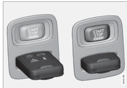
已拔出/插入遙控器之點火開關
