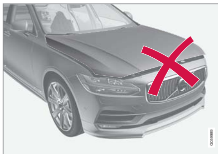
引擎蓋並未完全關閉。
