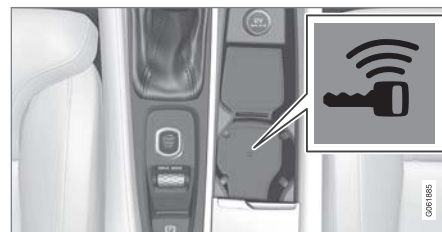
備用讀取器位於中央扶手控制台中。
