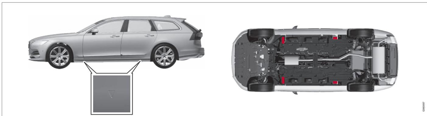
Emplacement des points de fixation du cric (triangles)/points de levage (zones rouges)
