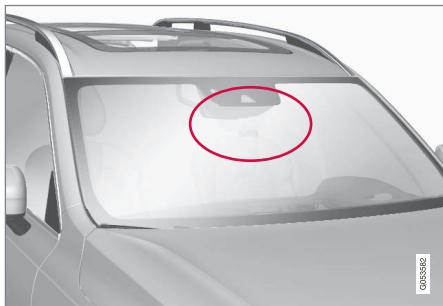
Emplacement du capteur radar
