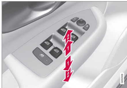
Fonctionnement des vitres électriques
