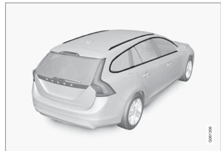
ชิ้นส่วนที่ควรล้างด้วยน้ำยาทำความสะอาดที่มีค่า pH ระหว่าง 3.5 ถึง 11.5
