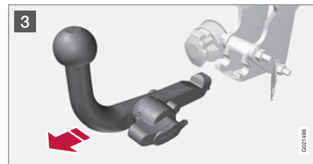
3 บิดปุ่มล็อกลงจนสุดกระทั่งถึงจุดหยุด จับไว้ในตำแหน่งนี้ในขณะที่ดึงตะขอพ่วงออกข้างหลังและดึงขึ้น
