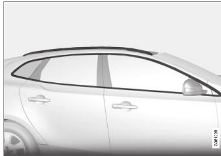
Detaljer som bør vaskes med et rengjøringsmiddel med en pH-verdi på mellom 3,5 og 11,5.
