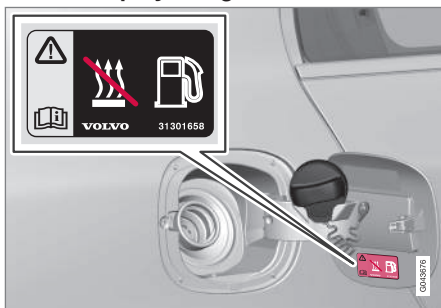
Advarselmærkat på tankdækselklappen.
