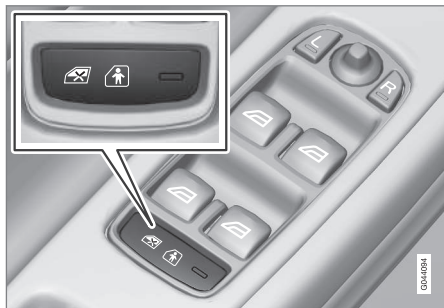
A vezetőajtó vezérlőpanelje.
