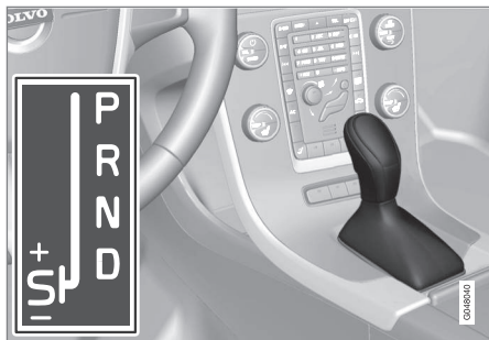
D - automata fokozathelyzetek. +S- - manuális fokozathelyzetek. S : sport üzemmód*.
