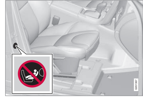
Alternatif 2: Hava yastığı etiketinin konumu yolcu tarafındaki kapı direğinin üzeridir. Etiket yolcu kapısı açıldığında görünür.
