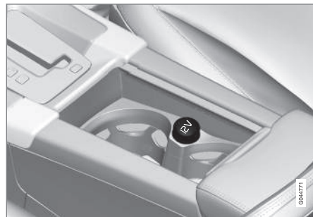
12 V-uttak i tunnelkonsoll, forsete.
