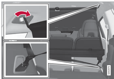
後段安裝位置。
