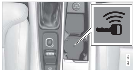
備用讀取器位於中央扶手控制台中。
