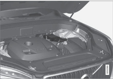
支援電瓶位於支撐桿旁的電瓶箱中。
