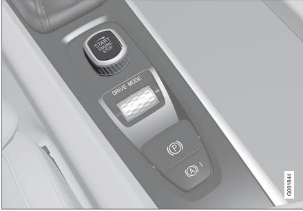
Tünel konsolundaki çalıştırma düğmesi.
