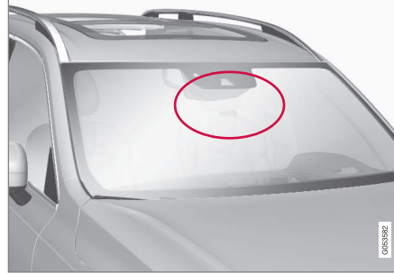
Radar ünitesi konumu
