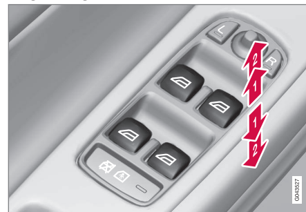
Regulering av vindusheiser.
