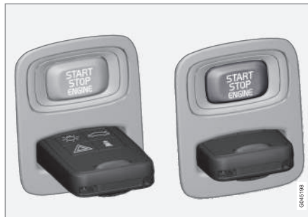
Вимикач запалення із витягнутим/вставленим ключем ДК та кнопка START/STOP ENGINE .
