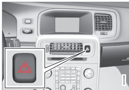
Кнопка аварійної сигналізації.
