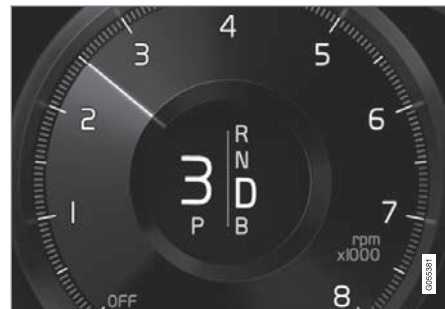
ステアリングホイールパドルでギヤをシフトしているときの、ドライバーディスプレイ
