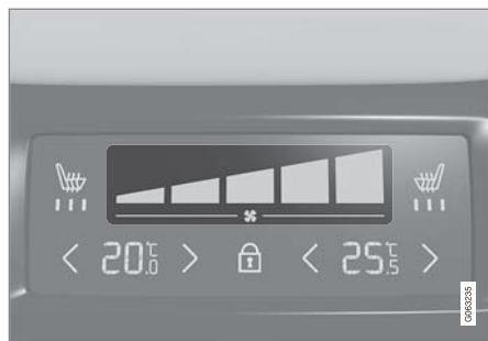
トンネルコンソール後部にあるクライメートパネルのファンコントロール
