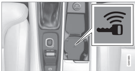
Backupdrevets placering i kopholderen.
