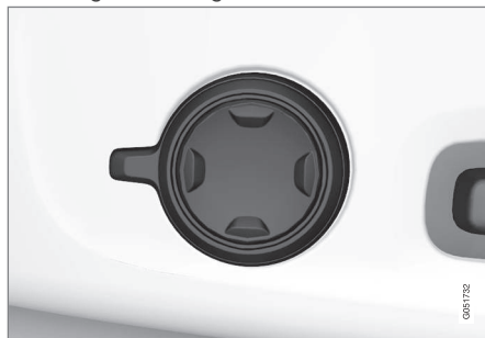
Multifunktionsknappen, placeret på siden af sædets siddedel.
