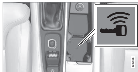
Backup-læserens placering i tunnelkonsollen.
