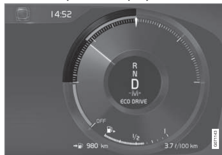
Eco-måleren på 12-tommer førerdisplay*.
