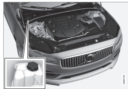
Ekspansionsbeholder for kølesystemet, venstrestyret bil.
