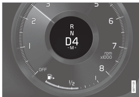
Førerdisplay ved gearskifte med ratpadler lille gearstang.
