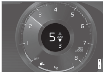
Gearskift-indikator på 12-tommer førerdisplay*.
