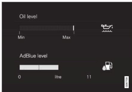
Gráfico do nível AdBlue no mostrador central.
