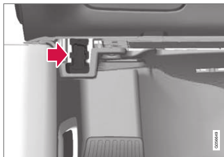
Рознімач (On-board Diagnostic, OBDII) для обміну даних розташований під панеллю приладів з боку водія.
