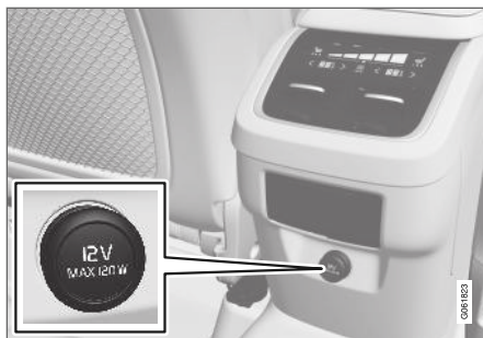
12 V-eluttag i tunnelkonsol, baksäte.
