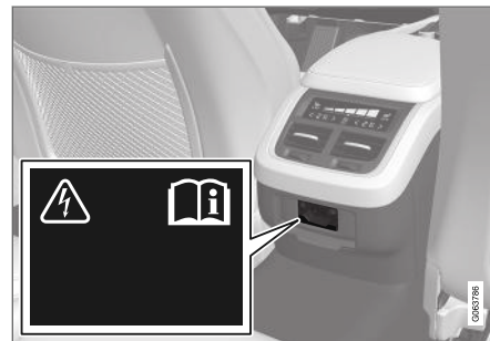
Eluttag i tunnelkonsol, baksäte.
