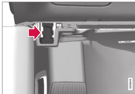
Duomenų ryšio jungtis („On-board Diagnostic“, OBDII) įrengta po prietaisų skydeliu, vairuotojo pusėje.
