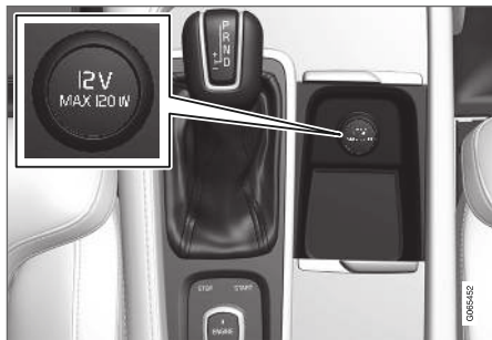
앞좌석 터널 콘솔의 12V 전원 소켓.
