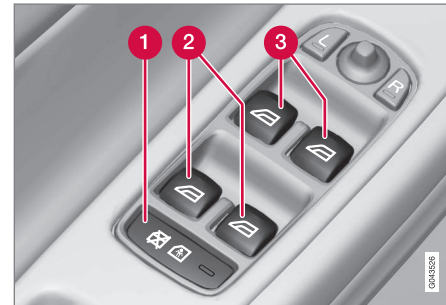
Säädinpaneeli kuljettajan ovessa.
