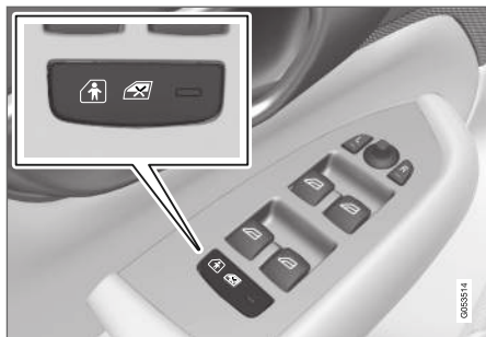
Pulsante di attivazione e disattivazione elettrica.
