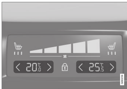
Comandi di temperatura sul pannello del climatizzatore sul retro del tunnel.
