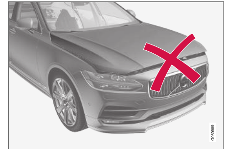
Cofano non completamente chiuso.
