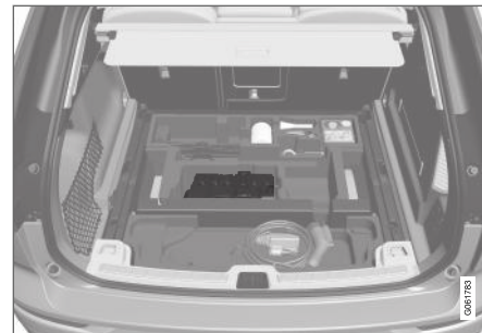
Starterio akumuliatorius įrengtas bagažinėje.
