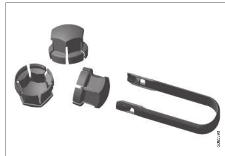
Plastikinių dangtelių nuėmimo nuo ratų varžtų įrankis.
