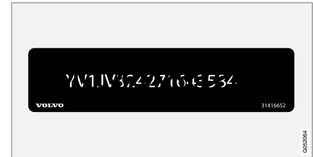
7 Automobilio identifikacinis numerio (VIN, transporto priemonės identifikacinio numerio) etiketė.
