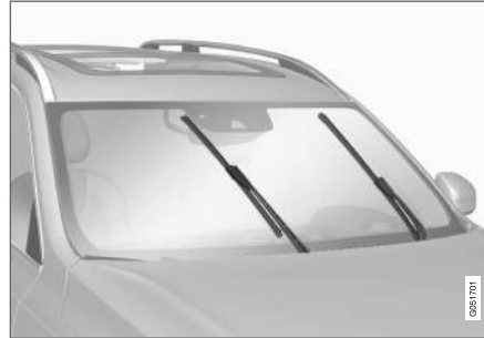
Valytuvo šluotelės aptarnavimo padėtyje.
