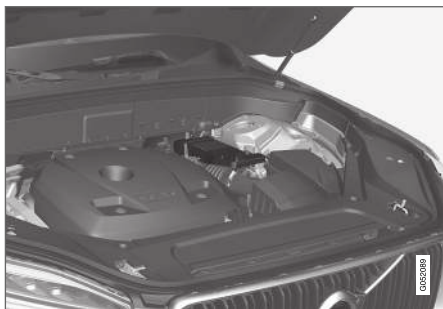
Pagalbinis akumulatorius yra dėžėje šalia statramsčio bokštelio.
