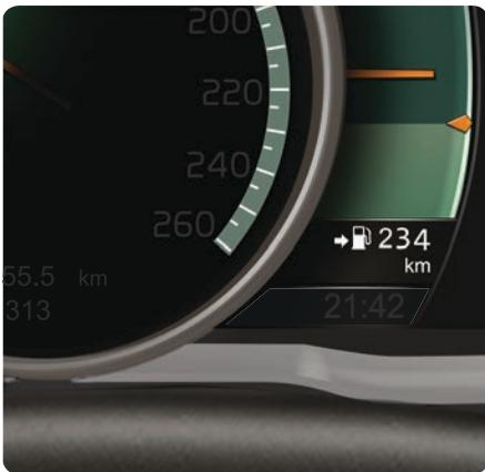
Il quadro strumenti mostra i chilometri di autonomia indicativi calcolati sulla base delle condizioni di guida precedenti e della quantità di carburante nel serbatoio.
