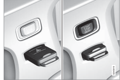
قفل الإشعال مع مفتاح التحكم عن بعد مفرودا/مدخلا وزر START/STOP ENGINE .
