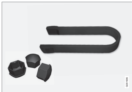
Työkalu pyöränruuvien muovihattujen poistamista varten.
