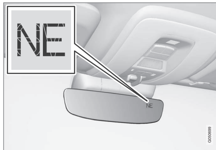
Kompassilla varustettu taustapeili.
