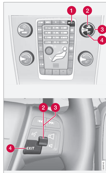
Painel de comando na consola central e unidade de botões no volante. A imagem é ilustrativa - a quantidade
