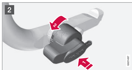
2 Pressione o botão de travagem e rode-o no sentido contrário ao dos ponteiros do relógio até ouvir um estalido.
