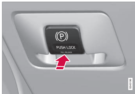
Comando do travão de estacionamento - aplicado.
