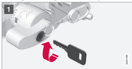
1 Insira a chave e rode-a no sentido dos ponteiros do relógio até à posição desbloqueada.
