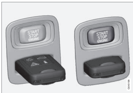
Interruptor de ignição com comando à distância ejetado/inserido e botão START/STOP ENGINE .
