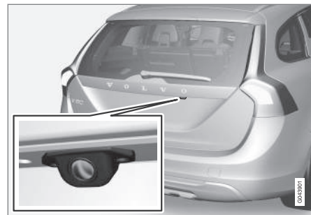
Ubicación de la cámara junto al tirador.
