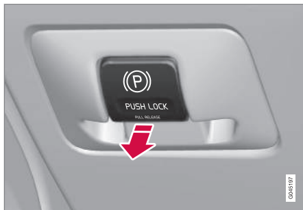
Mando del freno de estacionamiento - Liberación.
