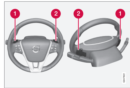
Las dos "paletas" del volante.
