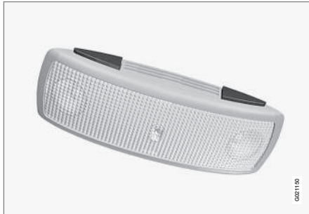
Iluminación trasera del techo.
