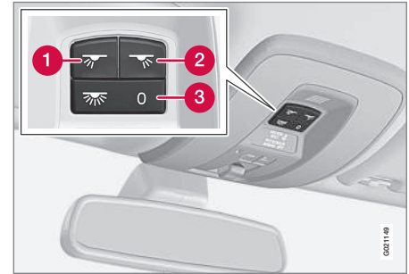
Mandos en la consola del techo para las luces de lectura delanteras y la iluminación del habitáculo.
