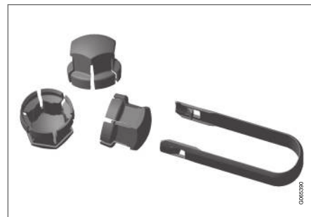
Nástroj pro sejmутí plastových krytek šroubů kol.
