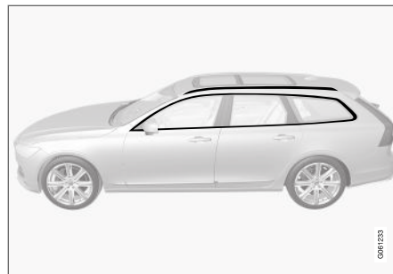
Díly, které by se měly mýt čisticím prostředkem s hodnotou pH mezi 3,5 a 11,5.
