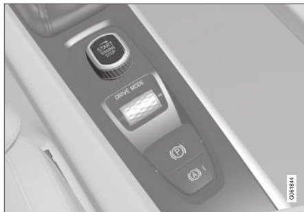
Startovací knoflík na tunelové konzole.
