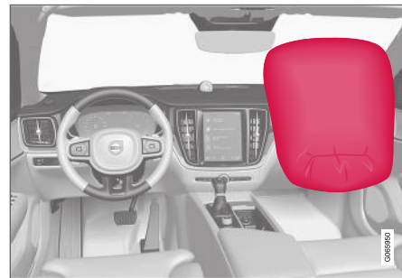
Airbag voor de voorstoel aan passagierszijde.
