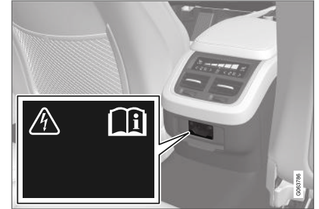
Stroomaansluiting in tunnelconsole, achterin.
