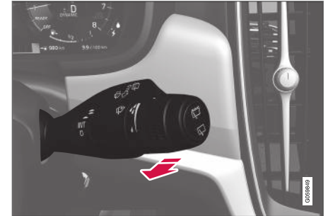
Sproeifunctie, rechter stuurhendel.
