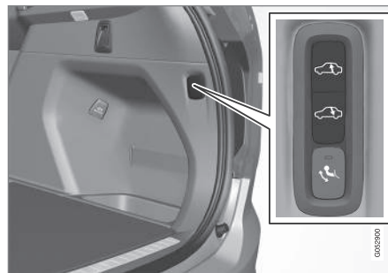
Az autó hátsó részét emelő/süllyesztő kezelőszervek
