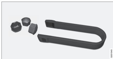
Szerszám a kerécsavarok műanyag sapkáinak eltávolításához.
