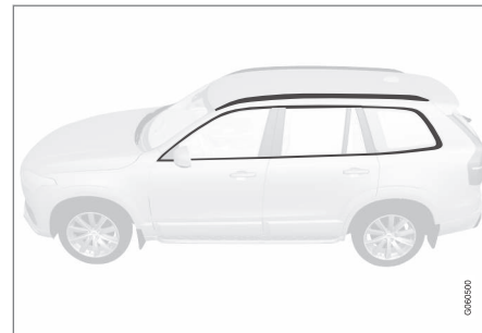
Alkatrészek, amelyek 3,5 és 11,5 pH-érték közötti tisztítószerekkel moshatók.
