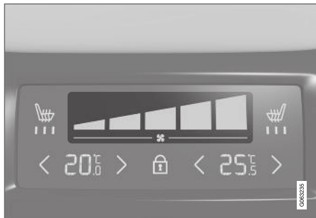
Ventilatorregeling op klimaatpaneel achter op tunnelconsole.
