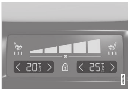
Temperatuurregeling op klimaatpaneel achter op tunnel-console.
