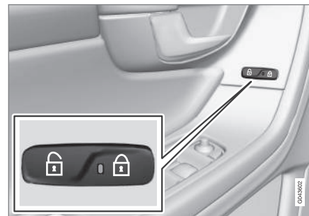
Przycisk centralnego zamka
