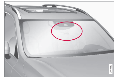
Ubicación de la unidad de radar.
