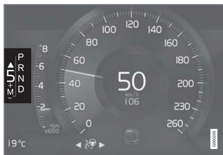
מחווך החלפת הילוכים בצג נהג 8 אינץ' עבור ידית בורר הילוכים גדולה.
