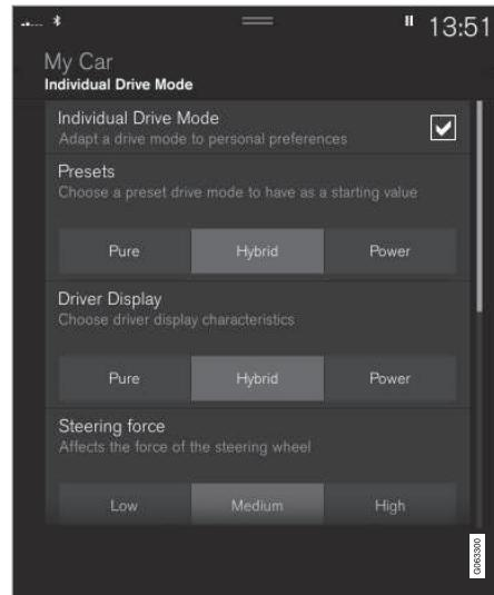
Vista de ajustes<sup>8</sup> para el modo de conducción individual.
