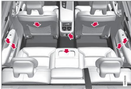
Compartimento en el panel de puerta, portavasos\* en el respaldo de la plaza central, bolsillo\* en el respaldo del asiento delantero y toma eléctrica en la consola del túnel.
