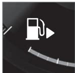
En la pantalla del conductor, la flecha junto al símbolo de repostaje indica el lado en que está situada la tapa del depósito.
