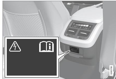
Toma eléctrica en consola del túnel, asiento trasero.
