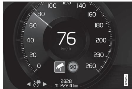
Ejemplo de información sobre cámara de control de velocidad y límite de velocidad en la pantalla del conductor.
