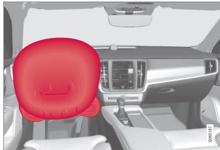
Airbag del volante y airbag de rodillas<sup>1</sup> en el lado del conductor del asiento delantero.
