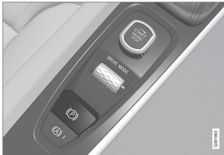
El control del freno de estacionamiento está situado en la consola del túnel entre los asientos.
