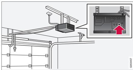
4. Busque el botón de aprendizaje<sup>19</sup> en el receptor de, por ejemplo, la puerta del garaje. Suele estar situado cerca de la sujeción de la antena en el receptor.
