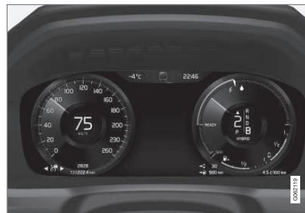
La pantalla del conductor muestra, entre otras cosas, información sobre la velocidad y, por ejemplo, llamadas telefónicas
