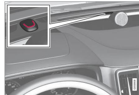
Cuando el automóvil está cerrado y la alarma activada, en el tablero de instrumentos parpadea una luz roja una vez cada dos segundos.
