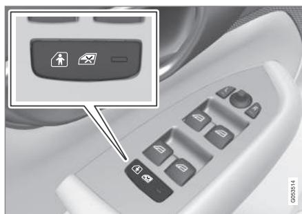
Botón de conexión y desconexión eléctrica.
