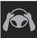
Si Pilot Assist detecta que el conductor no tiene las manos en el volante, tras unos momentos, indicará al conductor que conduzca el automóvil de forma activa mediante un símbolo y un mensaje de texto.
