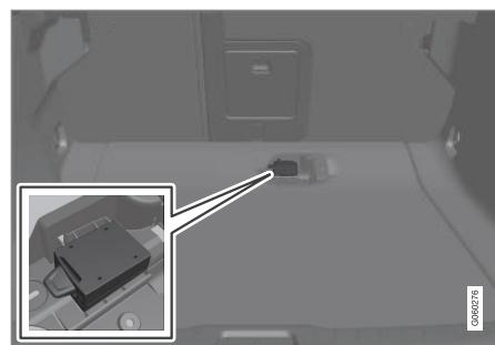
Coloque una tarjeta SIM personal en el soporte situado bajo el piso del maletero.
