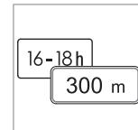
Algunas indicaciones de velocidad sólo son válidas, por ejemplo, durante un tramo determinado o un período específico del día. El sistema avisa al conductor sobre esta circunstancia con un símbolo de señal suplementaria debajo del símbolo de velocidad. El símbolo de la pantalla del conductor muestra entonces "DIST" o "TIME".
