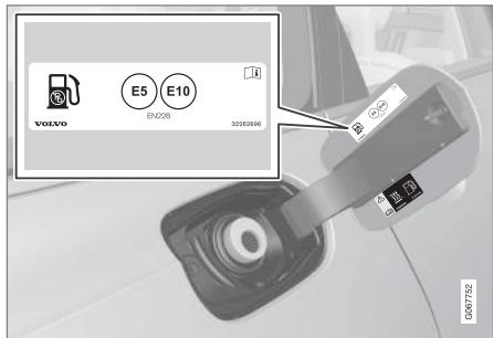
Seleccione el combustible homologado para su uso con el vehículo conforme al identificador<sup>10</sup> del interior de la portezuela del depósito. Consulte la información relativa a los combustibles homologados y el identificador en el apartado "Gasolina".
