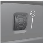
Con la rueda selectora del tablero de instrumentos a la izquierda del volante se regula la intensidad luminosa de la pantalla, la iluminación de los mandos, la luz circundante y la luz ambiental\*
