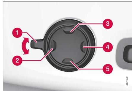
1. Active el control multifuncional girando el mando 1 hacia arriba o hacia abajo. La vista de ajustes del asiento se muestra en la pantalla central.
