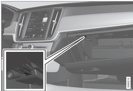
Lugar previsto para guardar la llave. La imagen es esquemática: el diseño puede variar.
