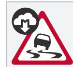
En caso de alarma por calzada resbaladiza, aparece este símbolo en el tablero de instrumentos cuando un vehículo se aproxima al tramo de calzada afectado, tanto en el automóvil propio como en otros vehículos que hayan recibido la información a través de Connected Safety.
