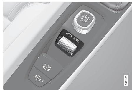
1. Pulse el control de modo de conducción **DRIVE MODE**.
