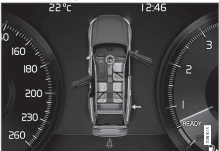
Gráfico en la pantalla del conductor con diferentes tipos de advertencias. El color de la advertencia de las puertas y el maletero depende de la velocidad del vehículo.
