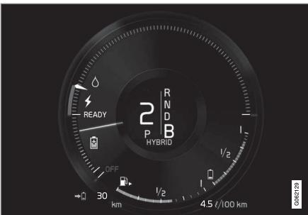
El vehículo genera corriente para la batería y la batería se carga, por ejemplo, cuando se pisa ligeramente el pedal de freno o al activar el freno motor al bajar por una cuesta.
