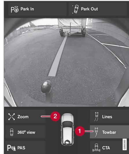
Enganche de remolque con línea auxiliar.
