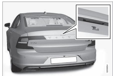
El pulsador de goma de la tapa del maletero puede utilizarse únicamente para desbloquear.
