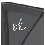
Para dar órdenes mediante comandos a través del sistema de control por voz, se establece un "diálogo" con el sistema. Pulse el botón del control por voz en el volante
