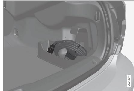
El cable de carga se guarda en el compartimento situado a la derecha en el maletero.
