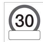
Un símbolo de señal suplementaria en forma de un marco vacío debajo del símbolo de velocidad<sup>97</sup> en la pantalla del conductor significa que la función ha identificado una señal con información suplementaria sobre la limitación de velocidad.
