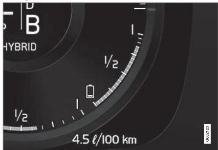
La energía de la batería híbrida se utiliza para el motor eléctrico, pero también para refrigerar o calentar el vehículo. El ordenador de a bordo calcula una distancia aproximada correspondiente a la cantidad de energía presente en la batería híbrida.
