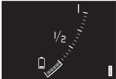
1. Si el índice de carga es alto, conduzca el automóvil hasta que quede aproximadamente un 25 %. Si el nivel de carga es bajo, cargue la batería hasta que se alcance alrededor del 25 %.
