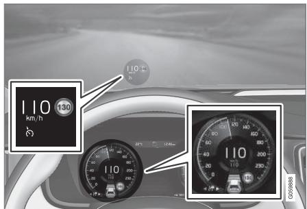
La imagen anterior muestra que se ha ajustado el control de velocidad constante adaptativo para mantener una velocidad de 110 km/h (68 mph) y que no hay ningún vehículo delantero que seguir.
