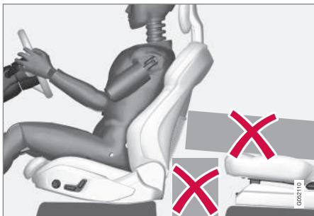
No coloque en el suelo detrás o debajo de los asientos delanteros o en el asiento trasero objetos que puedan impedir el debido funcionamiento del sistema WHIPS.
