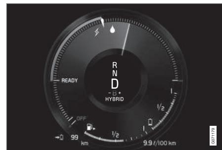
Pantalla del conductor cuando se utiliza tanto el motor eléctrico como el de combustión interna.
