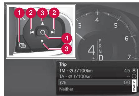
Abra y navegue en el menú de aplicaciones<sup>1</sup> con el teclado derecho del volante.
