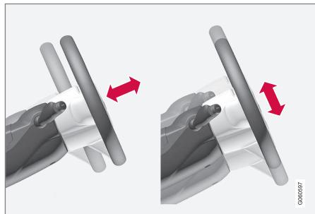
El volante puede ajustarse en profundidad y en altura.
