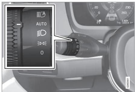
Mando giratorio de palanca izquierda del volante.
