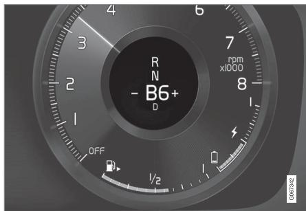
Indicador de cambio de marcha en la pantalla del conductor<sup>5</sup>.
