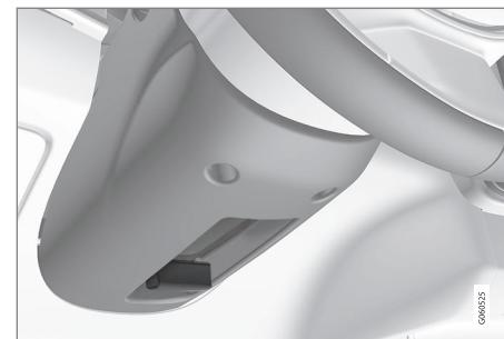
Palanca de regulación del volante.
