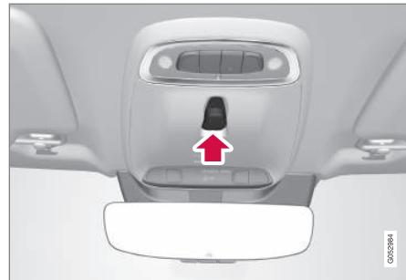
El techo solar se acciona con un mando que está situado en el techo. El mando se activa cuando el sistema eléctrico del vehículo está en la posición de encendido I o II.
