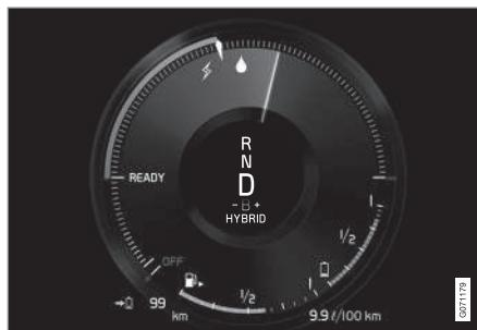
El motor eléctrico no puede suministrar la potencia que se solicita, por lo que arranca el motor de combustión interna.
