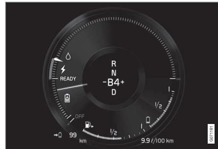
El vehículo genera corriente para la batería, la batería se carga, por ejemplo, al pisar suavemente el pedal de freno o al frenar con el motor cuesta abajo.
