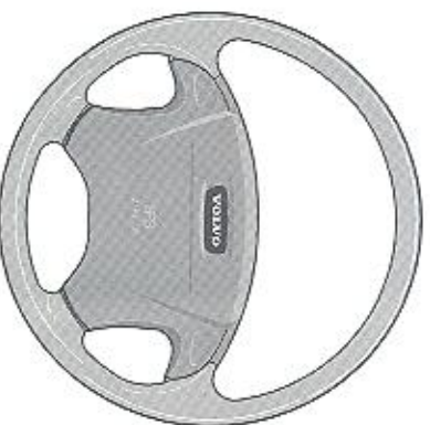
De airbag is in het midden van het stuurwiel ingebouwd en aangeduid met 'SRS'.
