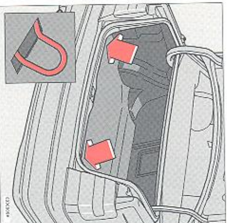
Verankeringsogen in de bagageruimte
