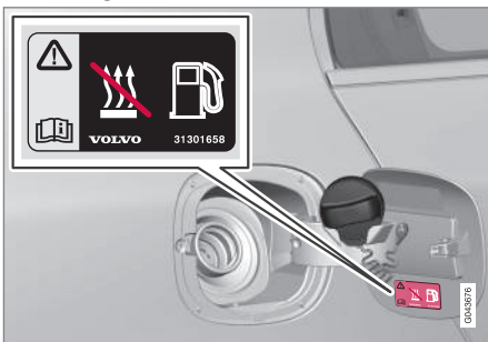
Varningsdekal på tankluckan.
