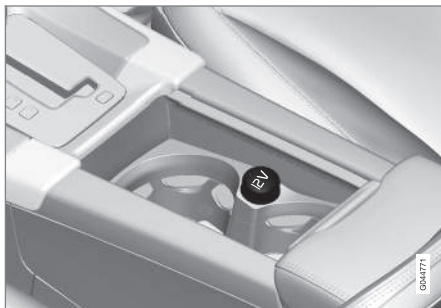
12 V-uttag i tunnelkonsol, framsäte.
