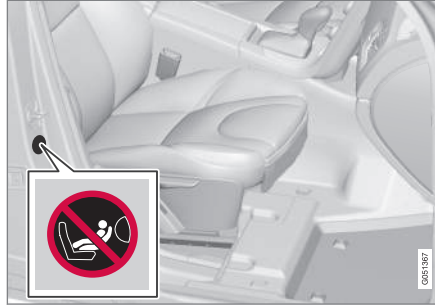
Alternatif 2: Hava yastığı etiketinin konumu yolcu tarafındaki kapı direğinin üzeridir. Etiket yolcu kapısı açıldığında görünür.
