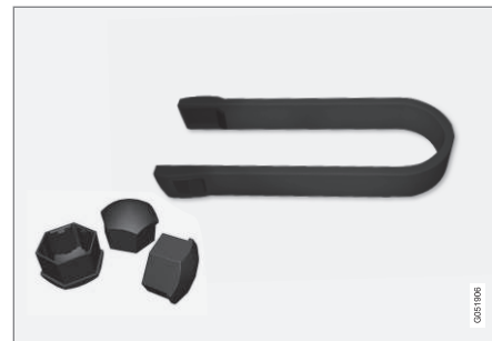
Demontagegereedschap voor kunststof boutafdekkingen.
