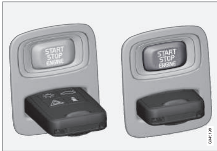
Contactslot met transpondersleutel uitgetrokken/ingedruwd.
