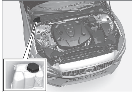
Réservoir de dilatation du liquide de refroidissement.
