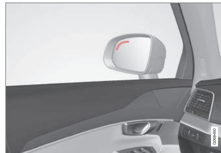
Emplacement de la lampe indicatrice BLIS.
