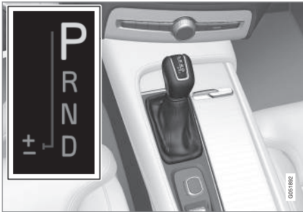
Vue d'ensemble du grand levier de vitesses et de la grille de rapports dans l'écran du conducteur.
