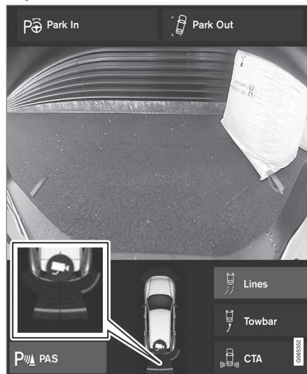
L'écran peut afficher des champs de capteur colorés sur le pictogramme de véhicule.
