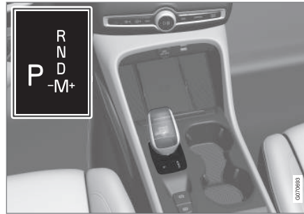
Vue d'ensemble du petit levier de vitesses et de la grille de rapports dans l'écran du conducteur.
