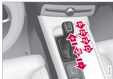
Vue d'ensemble du grand levier de vitesse et des vitesses.
