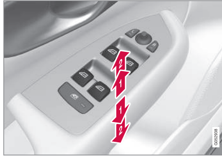
Fonctionnement des vitres électriques.
