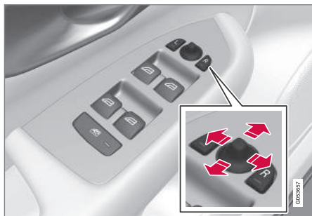
Commandes du rétroviseur latéral.
