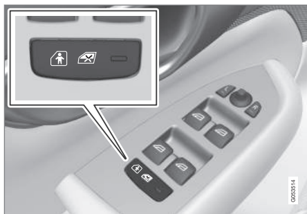
Bouton d'activation et désactivation électrique.
